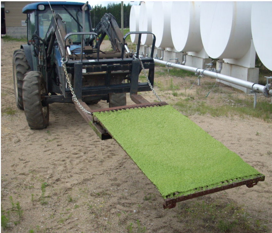
Figure B – Système de récupération des lentilles d'eau inventé par Martin
