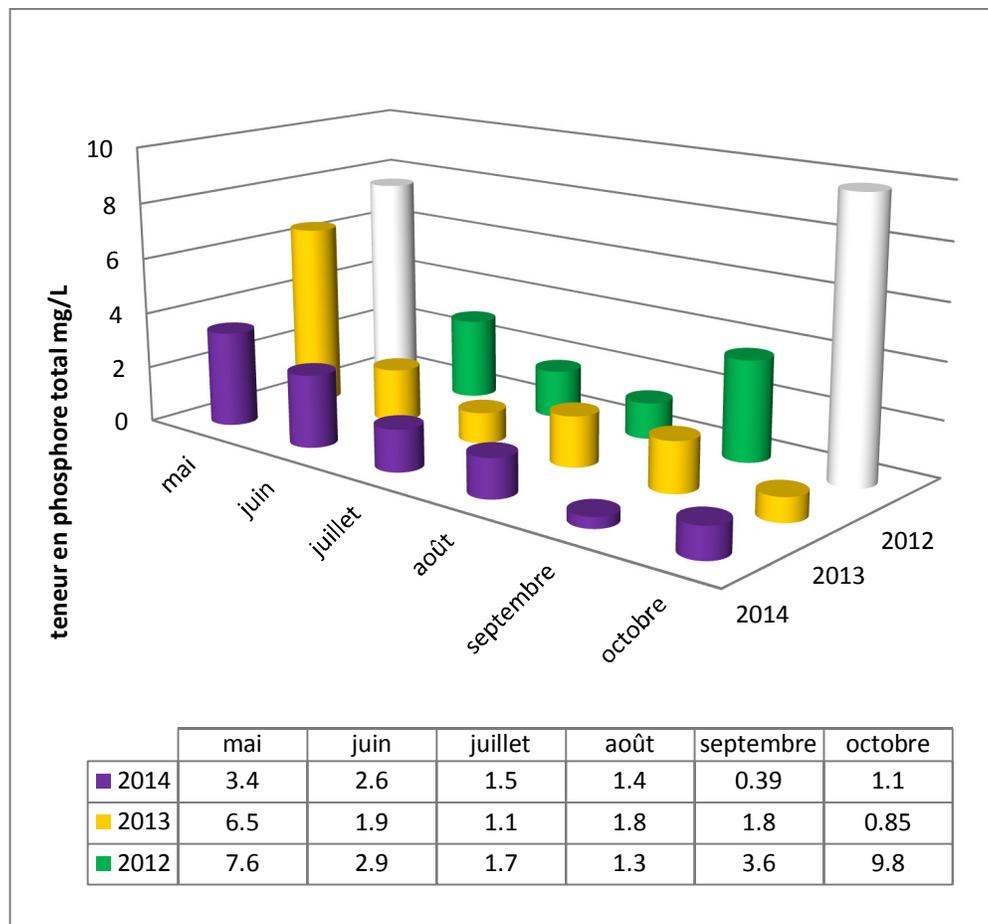
**Figure 7 - Concentration en phosphore total (mg/L) de l'effluent**
