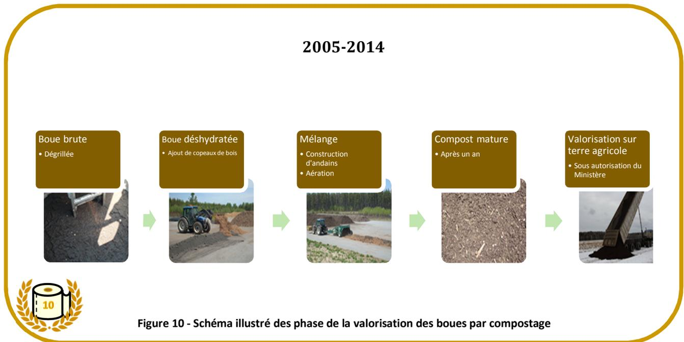
Figure 10 - Schéma illustré des phases de la valorisation des boues par compostage
