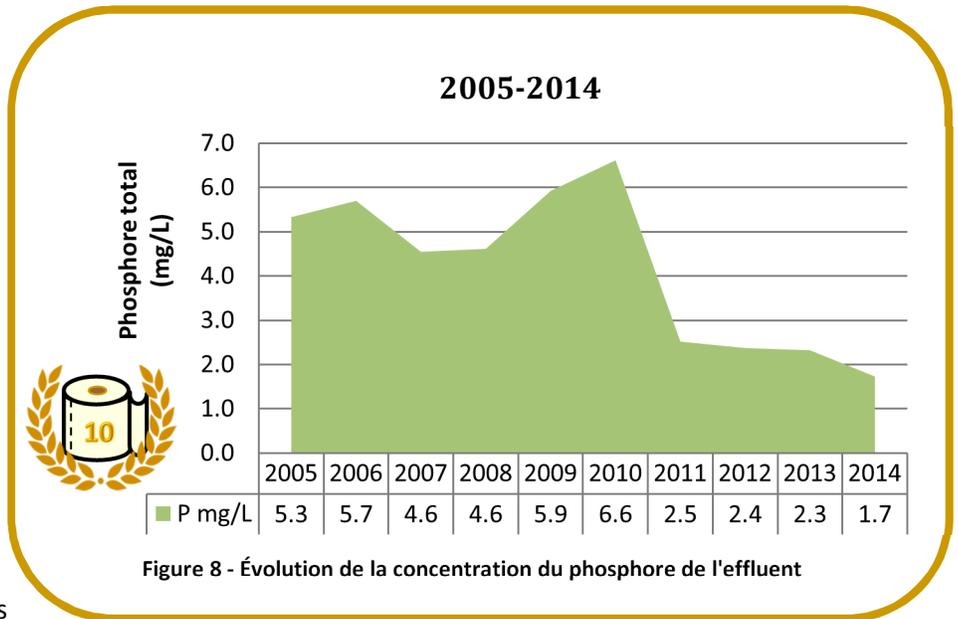
Figure 8 - Évolution de la concentration du phosphore de l'effluent
